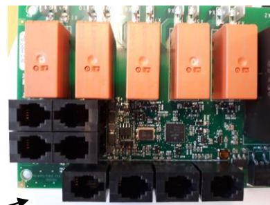
Joonis 6 . RJ 10 -konnektorite järjestus. Sensor, ukسلüliti, kaugjuhtimisseade, täiendav NTC
