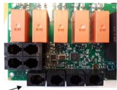
Imagen 6 Orden de los conectores RJ 10. Sensor, interruptor de puerta, control remoto, NTC adicional
